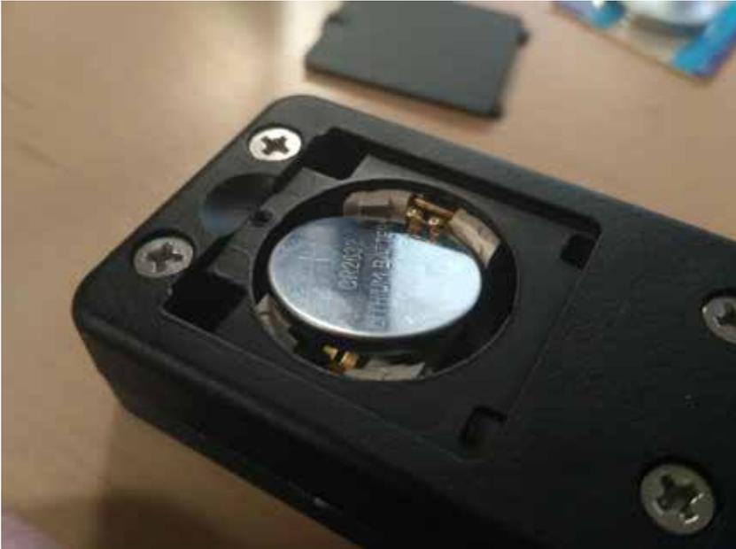
Legen Sie die Knopfzelle so ein, dass der **kurze Kontakt seitlich** anliegt, der längere Kontakt auf der Unterseite.
